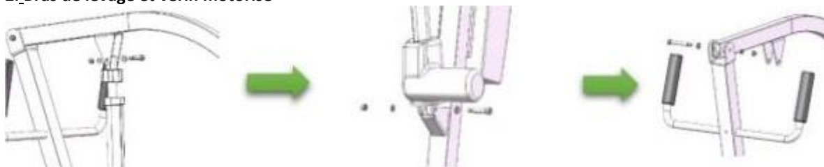
Fig. 3. Installation du bras de levage
