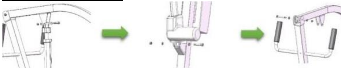
Fig. 3 Instalación del brazo elevador
