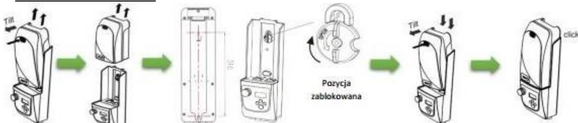
Fig. 4: Diagrama de instalación del controlador
