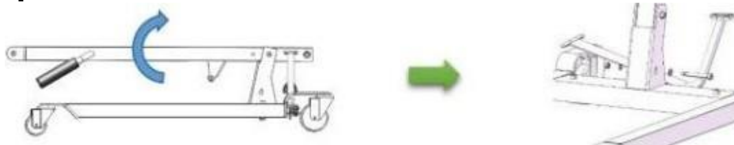
Fig. 2. Schéma de montage de la colonne de levage.
