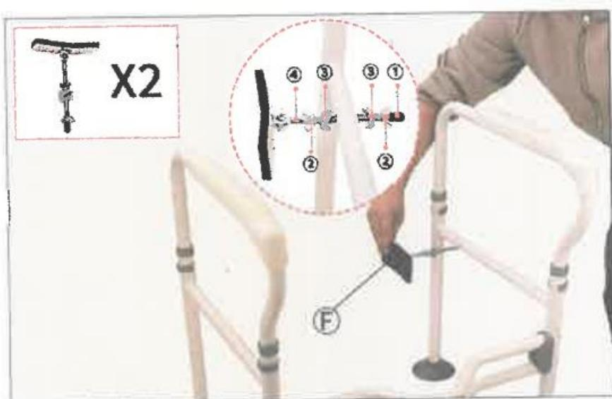
9. En primer lugar, afloje los tornillos de fijación, gire los bloques de fijación izquierdo y derecho en la dirección indicada en la imagen (asegúrese de que el izquierdo y el derecho estén equilibrados) y, a continuación, fíjelos con los tornillos de fijación.
