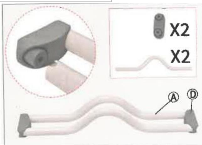
3. Inserte la pieza instalada (paso 2) en los soportes laterales (B), e introduzca los tornillos (G) en los orificios correspondientes, asegurándolos con la llave Allen (G).
