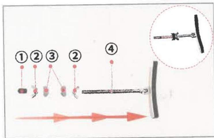
8. Assembler les petites pièces séparées à l'étape 7 de l'intérieur vers l'extérieur dans l'ordre suivant : 4, 2, 3, 3, 2 et 1.
