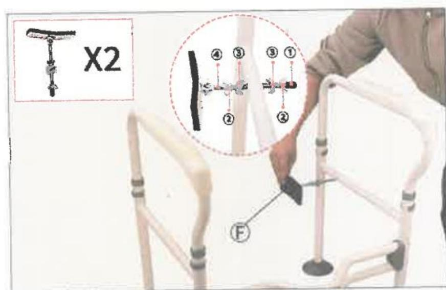
9. Tout d'abord, desserrez les vis de fixation, faites tourner les blocs de fixation gauche et droit dans le sens indiqué sur l'image (assurez-vous que la gauche et la droite sont équilibrées), puis fixez-les à l'aide des vis de fixation.
